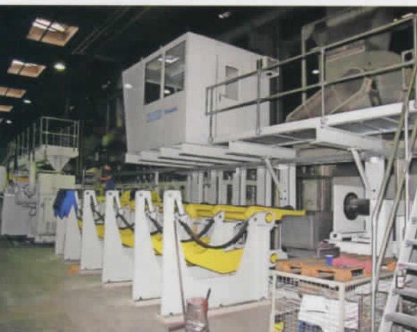
Die Stäbe werden in vereinzelt und anschließend über einen Rollgang der Richtpresse zugeführt.
