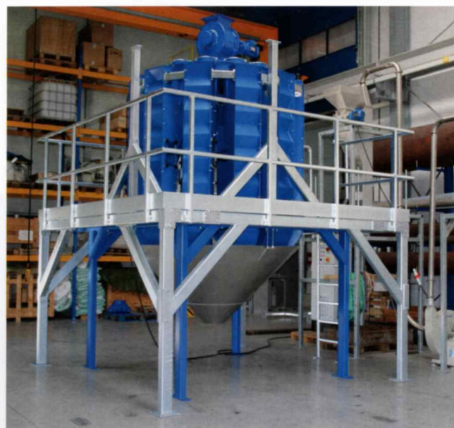
Im Zick-Zack-Sichter trennt ein Luftstrom unterschiedliche Kunststoffteile entsprechend ihren Schüttgewicht. Leichte Kunststoffe werden nach oben abgesaugt, schweres Mahlgut fällt nach unten
