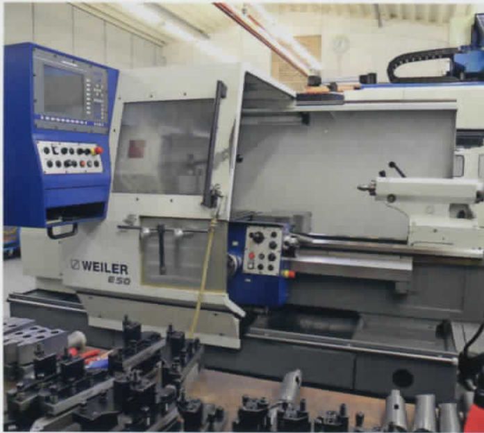
Eine zyklengesteuerte Präzisions-Drehmaschine E50 mit einem Umlaufdurchmesser über Bett von 570 mm.
