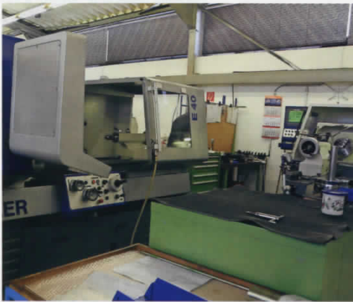
Die Maschinenhalle ist eng besetzt, links im Bild die Weiler E40, die kleinste und neueste Präzisions-Drehmaschine bei Schiffer Vakuum, 2013 gekauft.
