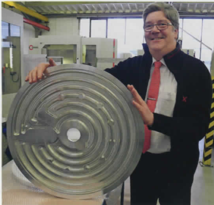
Geschäftsführer Johannes Schiffer mit einem Kühlmäander, einem Aluminiumbauteil für den Einsatz in Siliziumbeschichtungsanlagen.
